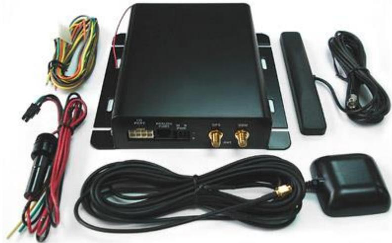
*Este dispositivo de localización automática de vehículos AVL de bajo coste y altas prestaciones ha sido diseñado para conectar con una amplia gama de módems GSM/GPRS, y módems Satélite (ORBCOMM). Trabaja con CDMA/1X, GSM/SMS & GPRS. La comunicación a dos bandas se basa en SMS, GPRS o paquetes de datos 1X.*
