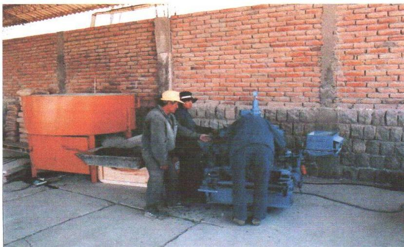
**Obr. č. 19 Část technologické linky ( horizontální míchač, ruční podavač, vibrolis Manual )**
