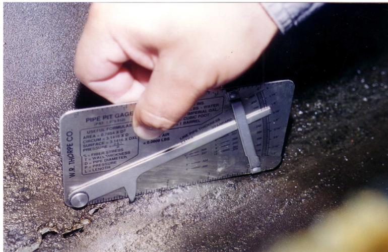
El riesgo de no aplicar oportunamente un buen programa de limpieza radica en que una gran acumulación de depósitos no permite obtener información durante el proceso de inspección y hasta puede llegar a obstruir una tubería.
