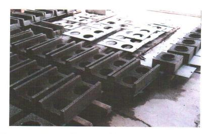
Obr. č. 21 Speciální tvárnice pro osazení do věnce a do překladů a poloviční tvarovky schnou na ocelových podložkách
