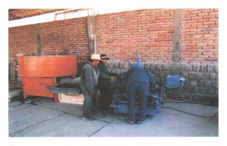
Obr. č. 19 Část technologické linky (horizontální míchač, ruční podavač, vibrolis Manual)
