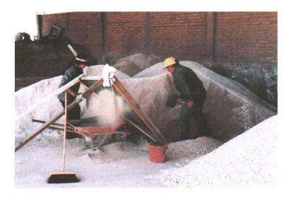
Obr. č. 17 Poloprovozní linka, třidiče pemzy, získávání frakce nad 4 mm
