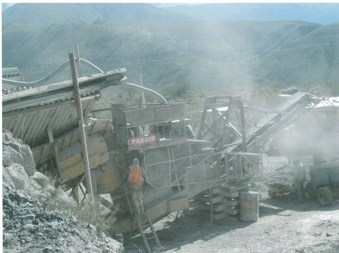
Fotografía No. 28 Trituradora en pleno funcionamiento
