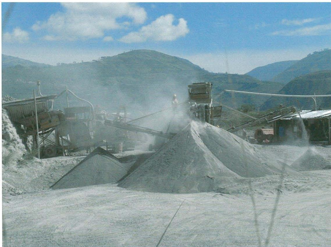
Fotografía No. 12 Trituradora obtiene tres clases de materiales
