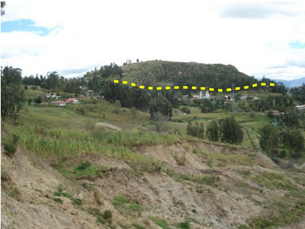
**Ilustración 4: Deslizamiento antiguo, reactivado por el nuevo**
